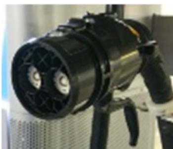
図 急速充電器の接続部
