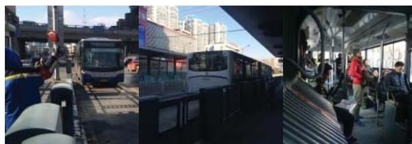
安全対策として、停留所にはホームドアを設置するとともに運転手に乗降の合図等を行う安全要員を配置している。車両は連結バスを使用している。（2015年11月25日筆者撮影）
