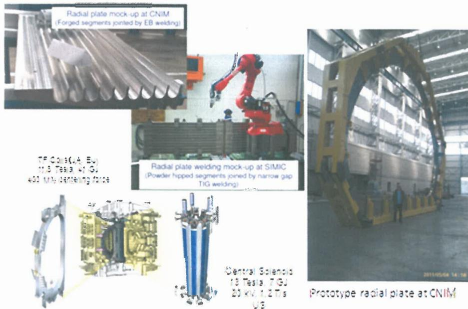
図2 建設の進む、トロイダル磁場コイルの超伝導導体を収納するラディアルプレートの製作現場 (EU)。
