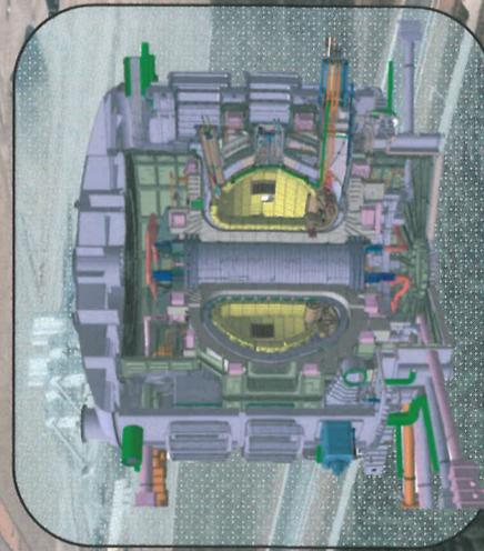
$R=6.2\text{ m}$ ,  $a=2.0\text{ m}$ ,  $I_p=15\text{ MA}$ ,
