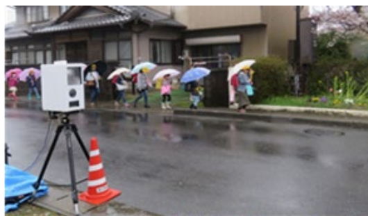
(可搬式速度違反自動取締装置による取締り状況)
