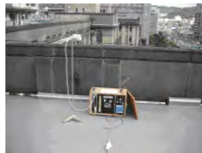
大気中アスベストの測定の様子
